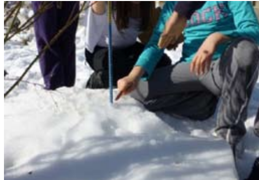
Figure 1. Photos lors de l'intervention du premier chercheur (S. Gascoin) : mesures et analyse des hauteurs de neige
