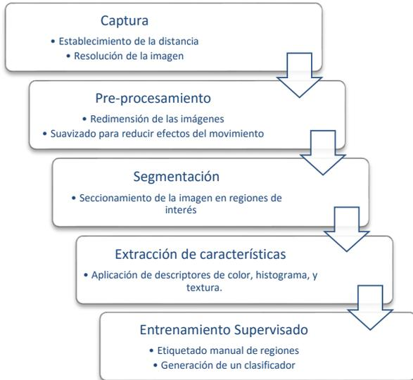
**Figura 6.** Fases del modelo para categorización de contaminación petrolera.
