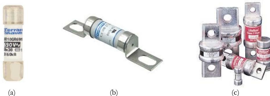
Figure 12 : Exemples de fusibles type *fuselink* pour la protection de composants semi-conducteurs : (a) Mersen 690 V/1-32 A [14], (b) Mersen 690 V/12-100 A [1] et (c) Littelfuse 300-600 VAC/1-1200 A [21].
